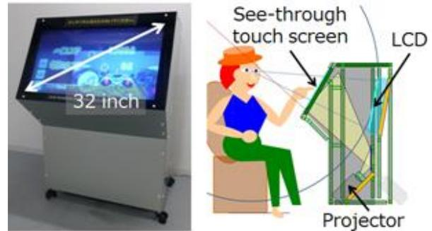
図6 インタラクティブシステムの外観写真と構成図
