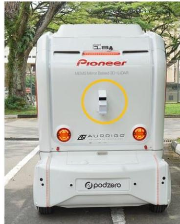
【Autonomous shuttle bus with Pioneer’s 3D-LiDAR sensor】
