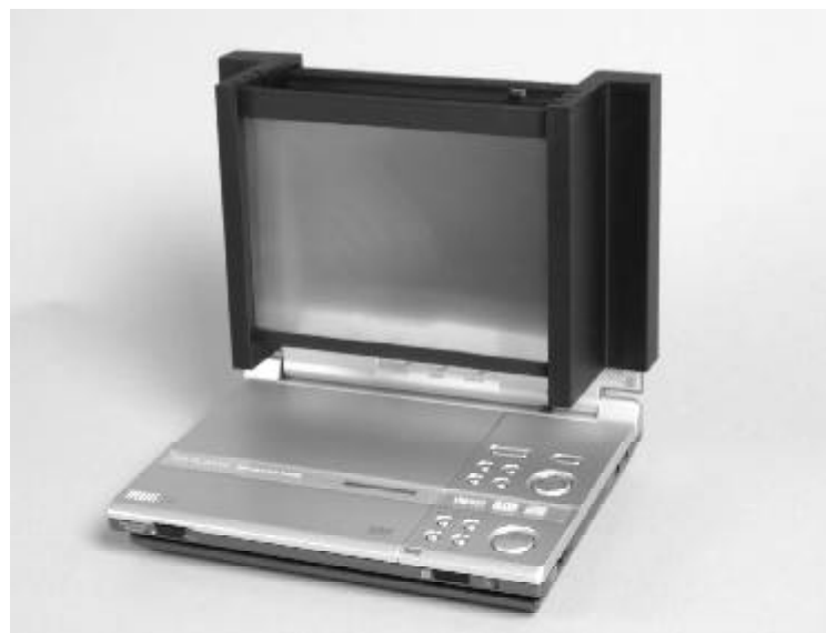
図8 めがね無し小型立体表示装置(試作品)の外観
