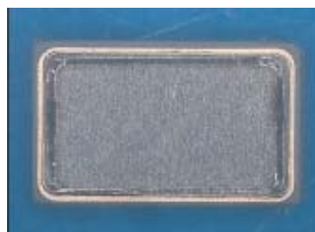
(b) 連続(CW)レーザーによる封止
